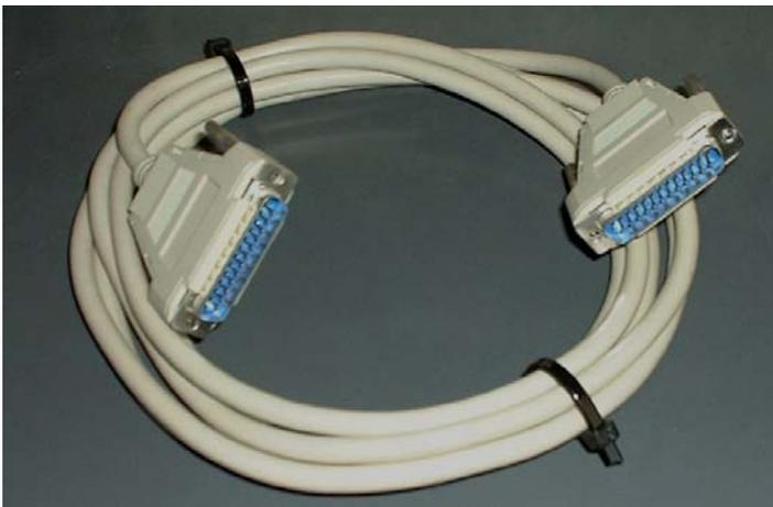
Isel ステージケーブルはリーダーユニットをコンピュータ/コントロールユニットのIsel モーターコントロールカードに接続します。
