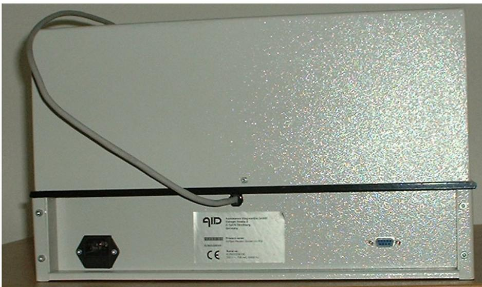
ELR02-c 背面 (左から) : ヒューズ付き 240 V または 120 V 電源ケーブルソケット、FireWire カメラケーブルおよび仕様ラベル、ステージドライバ用シリアルポートケーブルソケット。
