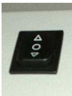
プレートの中央にあり、スポットを含んでいるウェルを選択します。カメラプレビュー画面を呼び出し、リーダーユニットのボタンでフォーカスを調整します。上記のステージキャリブレーションを再度実行します。
