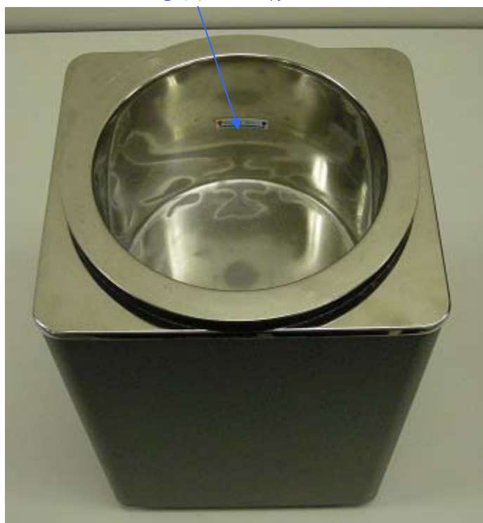
写真-4 破碎ユニット水位レベル
