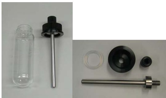
写真-8 チューブユニット
