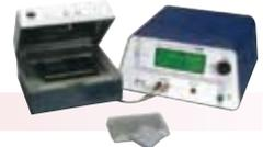
専用マルチウェルプレートに対して1列ごとに通電・パルス出力を行います。キュベットよりも一度に多くのサンプルを処理することのできるハイスルーブット対応のシステムです。
