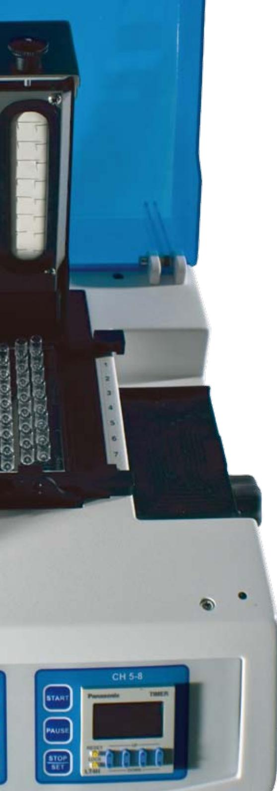
インタクトタンパク質を泳動ゲルから速く、効率的に回収する為の電気溶出装置です。
