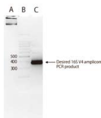
図2 2%アガロースゲル A: E. coli ゲノムDNA 250ng B: 分子量マーカー C: 本キットによるPCR生成物 (30サイクル、50ngの E. coli ゲノムDNAをインプット)
