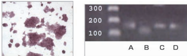
(左図) 未分化D3細胞のアルカリホスファターゼ染色像 (右図) マウスES細胞 (ES-D3) におけるOct-4とNANOGのRT-PCR分析 トータルRNAを未分化ES-D3を分離し、5μgのトータルRNAをcDNA合成に使用。PCR反応はトータルボリューム50μlで30サイクル、55℃のアニーリング温度で行った。
