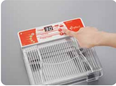
出力電圧は5種類 (50 V, 75 V, 100 V, 120 V, 135 V)。
