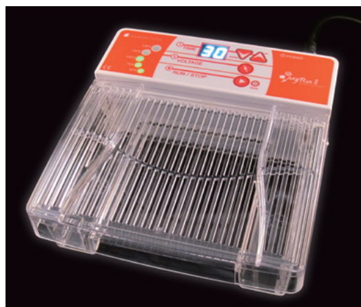
図1 泳動槽とパワーサプライの一体型。放熱性とゲルの視認性に優れた蓋デザイン。ゲルトレイだけでなく、泳動槽もUV透過性を確保。
