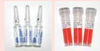
乾熱滅菌用バイオリジカルインジケータは、他の ACE test® とは異なり、指標菌と培地が別々のバイアルに入っており、ケミカルインジケータは付いていません。乾熱滅菌をかけるガラス容器の中に指標菌アンプル(品番:H6302)を入れ、乾熱滅菌をかけます。その後、アンプルから指標菌が付いたガラス繊維濾紙を取り出し、専用培地(品番:H6302M)に入れて培養します。
