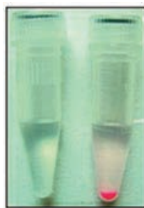
図2 GCMビーズ（右）と一般的なビーズ（左）の比較。GCMビーズは、マゼンタ色なので回収時のロスが少ない。
