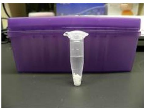
7. 泥状物(50  $\mu\text{L}$ )を操作 5 で得られたチューブの中に加える。
