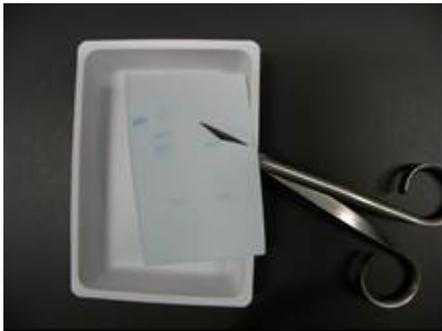
2. 切り取ったバンドを少量のメタノールで湿らせ、苛性ソーダ水溶液に溶解した水素化ホウ素ナトリウム溶液(500 mM NaBH<sub>4</sub> in 50 mM NaOH)の 40  $\mu$ L を添加し、45 °C にて 16 時間インキュベートする。
