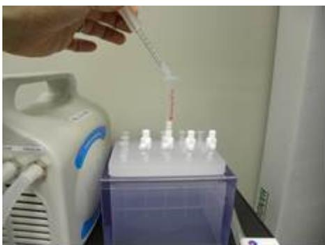
12. メタノール(50  $\mu$ L)を固相抽出カートリッジに添加し浸み込ませた後、50%アセトニトリル(1 mL)を用いて溶出し、新しい 1.5-mL のサンプルチューブに回収する。遠心エバポレーターで濃縮乾固する。
