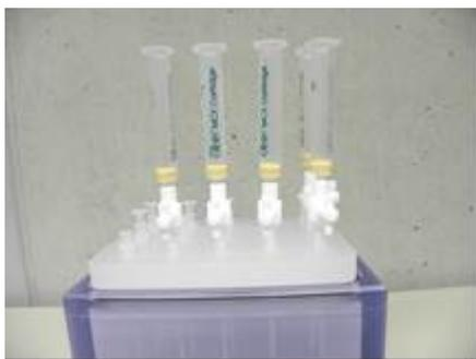
5. 1% (v/v)の酢酸を含むメタノール 100  $\mu\text{L}$  をチューブに加え残渣を溶解させる。遠心エバポレーターにて濃縮乾固する。この操作を 2 回繰り返す。
