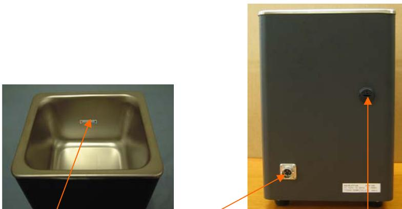
⑮水位レベル線 ⑬破砕ユニットコネクター ⑭保持プレートモーターコネクター
