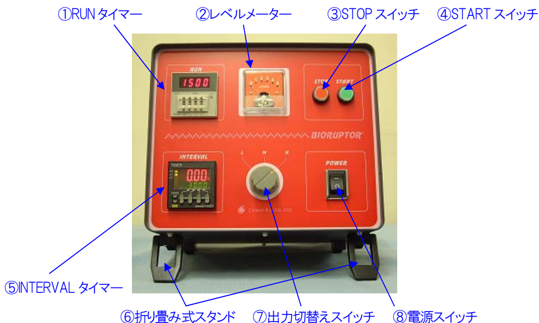
写真-1 発振ユニット正面
