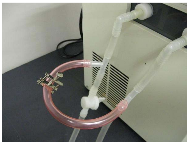
写真-2: バイパスライン
