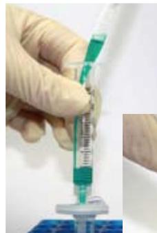
③ それぞれのフィルター内の微小粒子由来のRNAをBioPure™-MP RNA抽出試薬を用いて抽出します。
