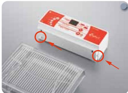
パワーサプライには泳動槽または蓋との接触確認スイッチを設置。
