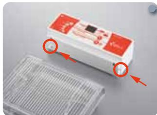
パワーサプライには泳動槽または蓋との接触を確認する安全スイッチを設置。
