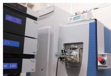
図1 Q-Exactive HF-X(Thermo Fisher Scientific社)
