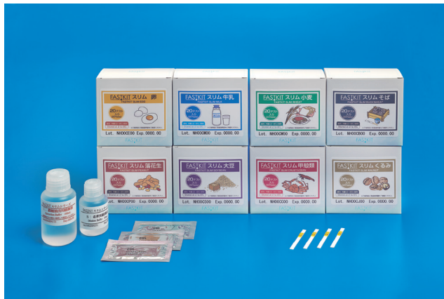
図 サンプル中の抗原と金コロイド標識抗体が結合し、固相化された目的物質に対する抗体と反応することで赤紫色のラインが出現
