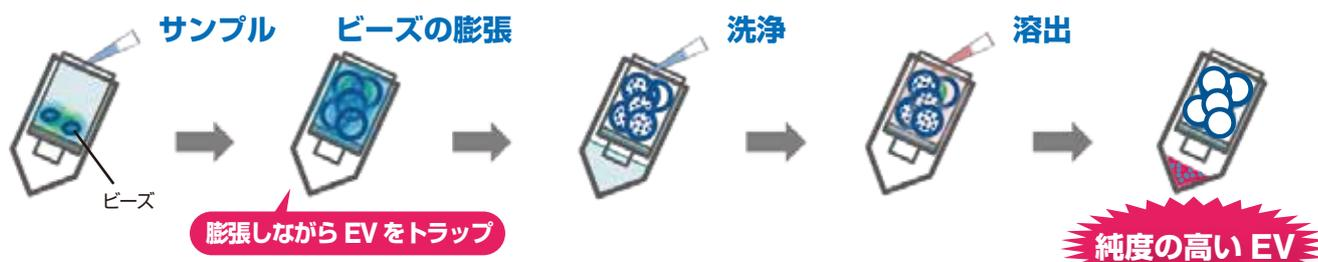
ハイドロゲルビーズの入ったスピンカラムと付属の Wash buffer、Elution buffer を利用します。
