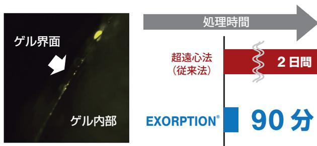
図2 エクソソームモデル物質の吸着現象 (蛍光顕微鏡)。
