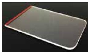
培養プレートを温めて、プレートのフタの結露を防ぐガラスプレートです。高い光透過性と透明度を持ち、光学的歪みがほぼなく、顕微鏡観察に適しています。素材、および厚みは熱が逃げにくいように工夫されています。
