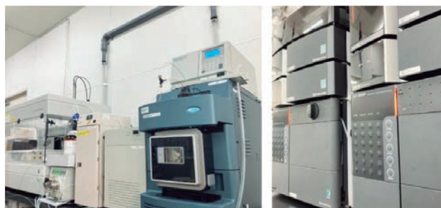
(左) 精製用LC-MS (LC Prep AutoPurificationシステム / Waters™) (右) 精製用HPLC (LC-20およびLH-40 / 島津製作所)
